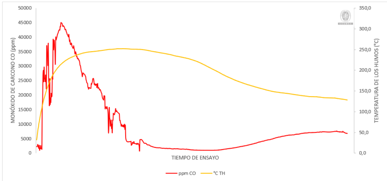
Gráfico N°21: Evolución de la temperatura de los humos y la emisión de monóxido de carbono durante el ensayo de un calefactor con leña semi húmeda sin filtro.
