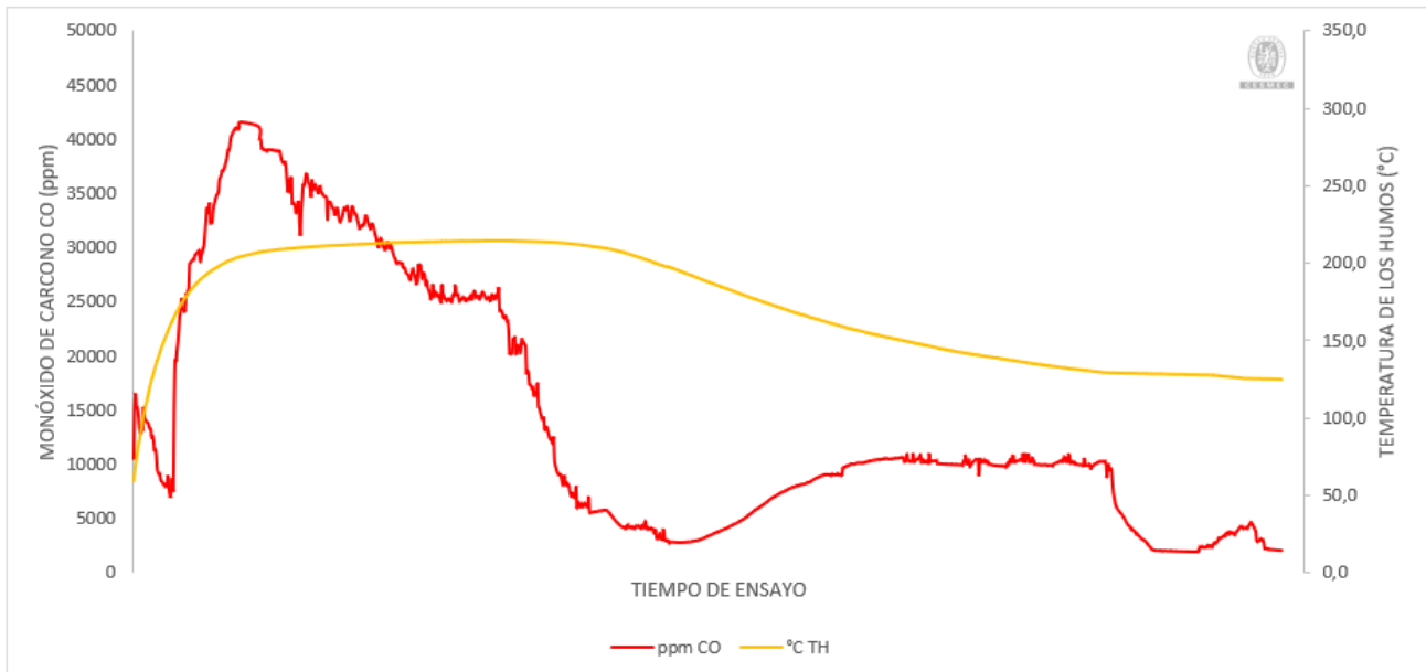
Gráfico N°22: Evolución de la temperatura de los humos y la emisión de monóxido de carbono durante el ensayo de un calefactor con leña semi húmeda con el WSF-CUB-5-200.
